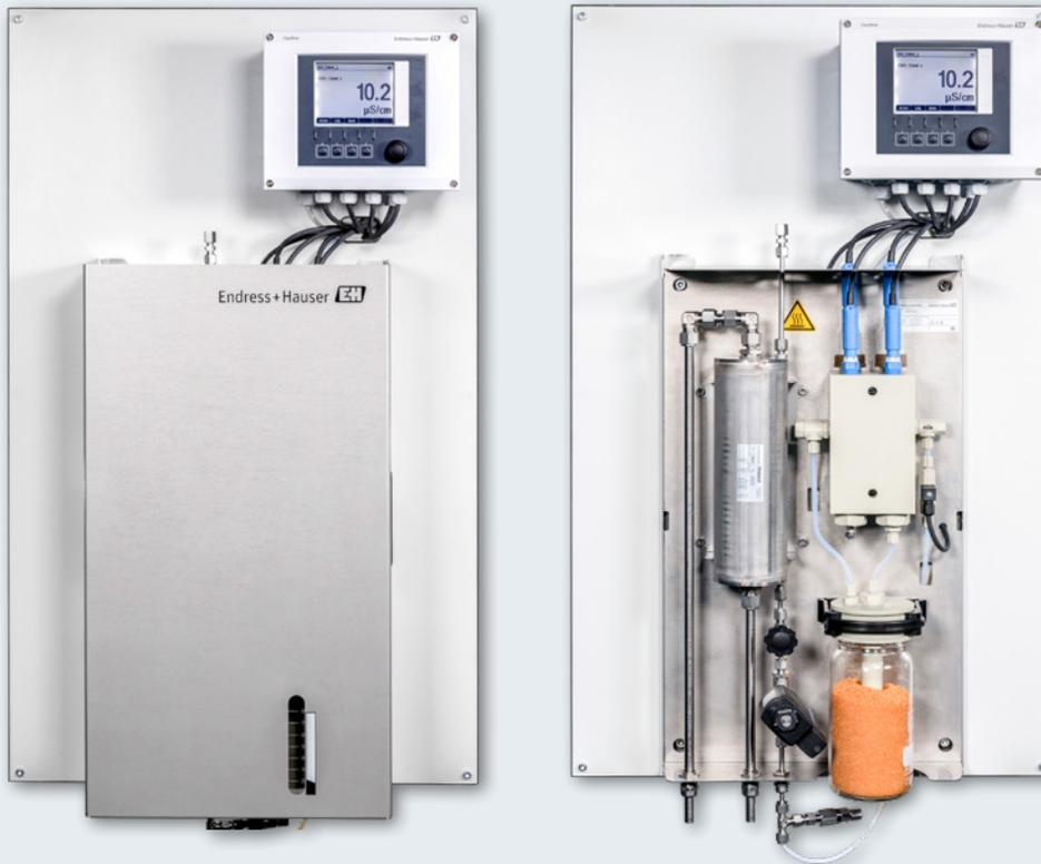
Platzsparend und anschlussfertig: SWAS Compact umfasst die Probenvorbereitung, einen Kationenaustauscher, einen Liquline Multiparameter-Messumformer und Steckplätze für bis zu 4 Sensoren, z.B. für die pH-, Leitfähigkeits- und Sauerstoffmessung.
